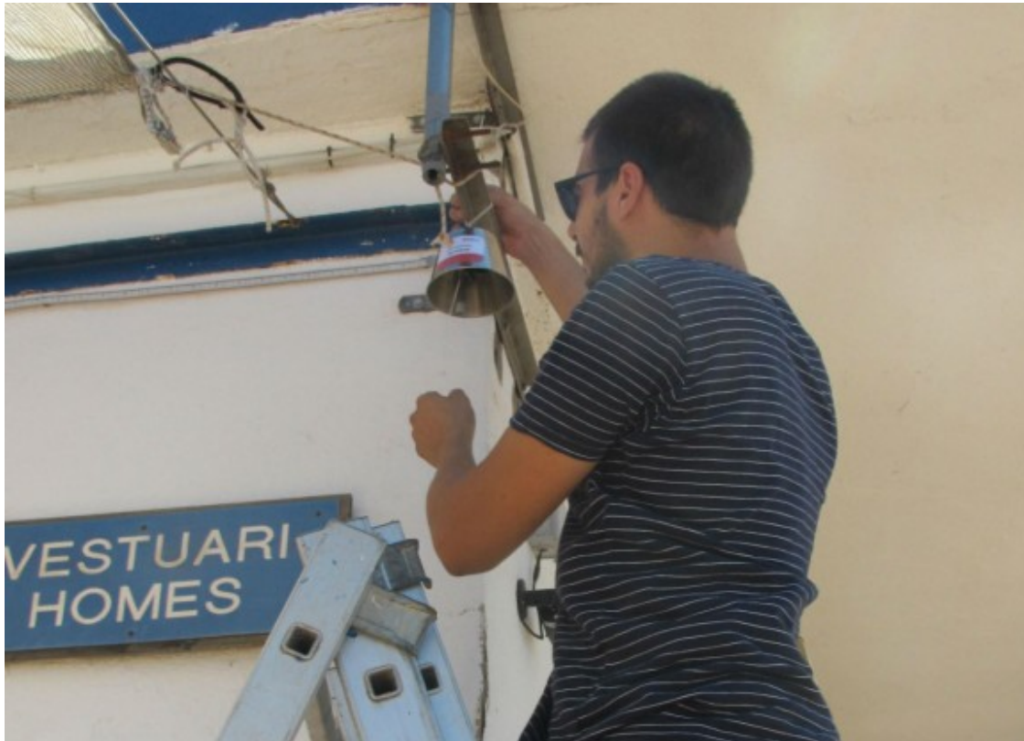
Un tècnic ambiental col·locant un dels sensors que permetrà fer un seguiment de la qualitat de l'aire Foto: Mare Terra
