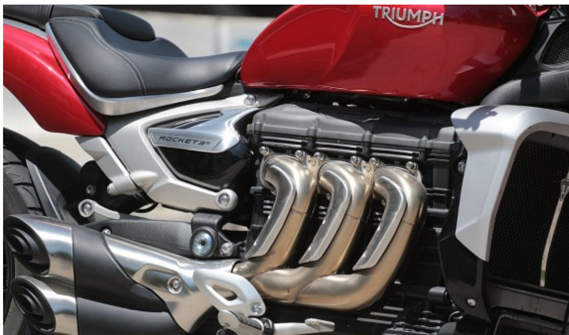
Tres cilindres i 2500 cc. El motor més gran muntat en una moto de sèrie Foto: F.Boada
