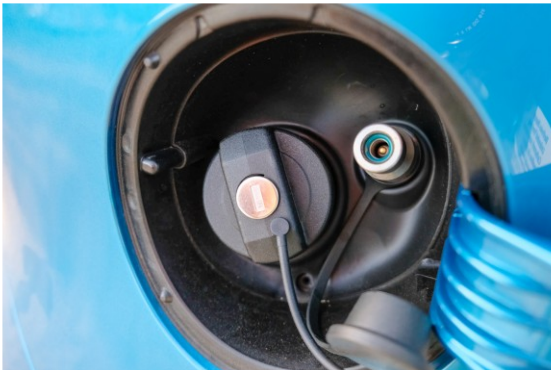
El Mii GNC té dos dipòsits el de benzina i el de gas Foto: Marc Calvo
