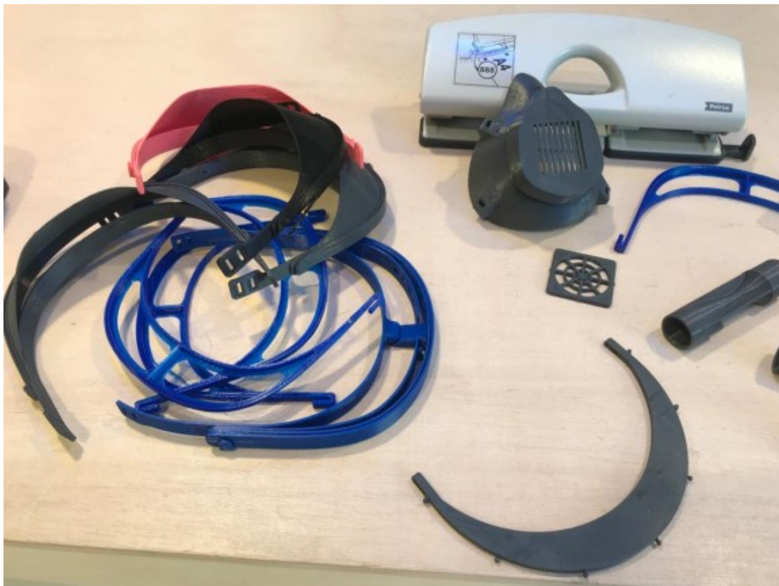
Viseres de protecció confeccionades a FABLAB Foto: FABLAB
