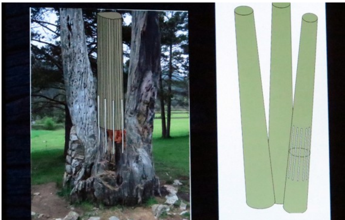
Estructura per recol·locar la branca al Pi de les Tres Branques
